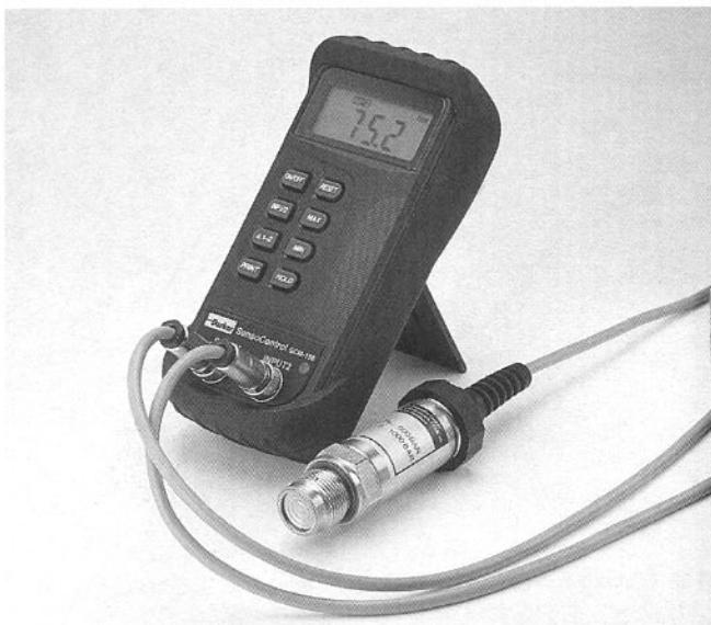
圧力・流量・回転速度・温度を1台で計測します
