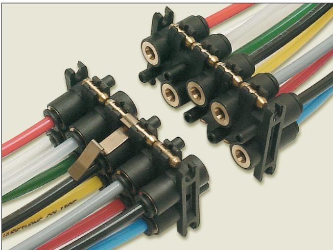
モジュール構造により。複数のチューブが一回の簡単な操作により脱着ができます。内部のオス/メスコネクタ構造が確実な結合で漏れのない接続を可能にしています。どのような長さのユニットも構成できます。1セットで10回路の配管に対応します。
