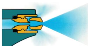
ノズル先端が塞がれると、空気はノズルの脇の小さな穴から出るので安全です。
