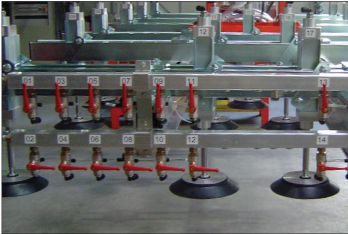
レグリの標準ボールバルブは流体の確実な開閉をお約束します。使用にあたっては、2方の場合には1/4回転、3方の場合には180度回転させるだけです。
